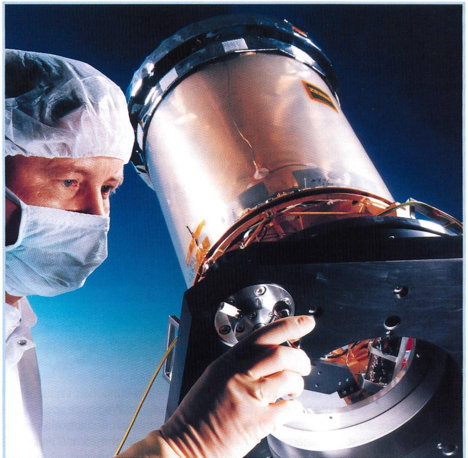
Bild 5. Montagearbeiten am SILEX-Teleskop (Foto: Zeiss).
