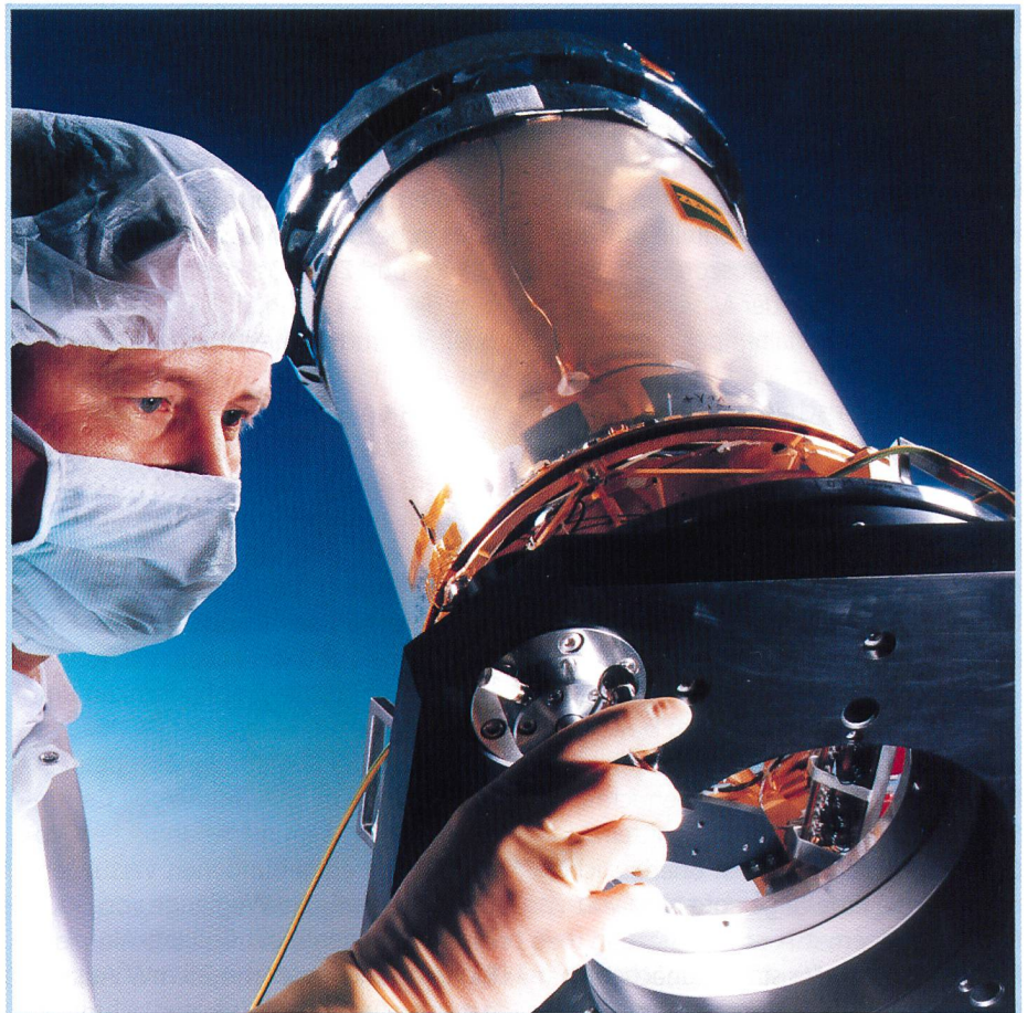
Bild 5. Montagearbeiten am SILEX-Teleskop (Foto: Zeiss).
