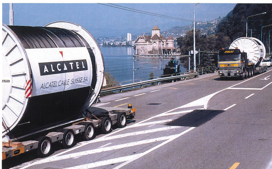
Kabelhaspel-Transport mit Tiefladern.
