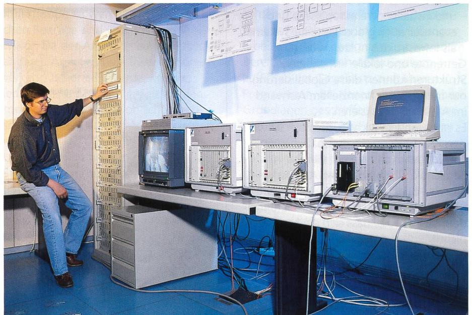
Bild 5. Blick in die Forschungsräume des Swiss National Host. Einspeisung der TV-Programme in die ATM-Plattform. TV-Programme werden via Satelliten-Kommunikations-Empfangseinrichtungen via Video-Coder dem ATM-Terminal-Adapter (Sender) zugespiesen (Bilder 5 bis 7: H.R. Bramaz)
