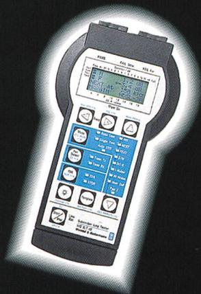
... finden Sie einfach und schnell mit den neuen Leitungstestern für hohe Übertragungsraten. Damit sind Sie für DMT, CAP und andere xDSL-Technologien bestens ausgerüstet. Ein Tastendruck genügt, um die Verbindungsleitung mit dem Tester WG SLT-22 gründlich zu analysieren. Kurze Meßzeit und automatische Ergebnisauswertung reduzieren die Kosten. Testen Sie es!
