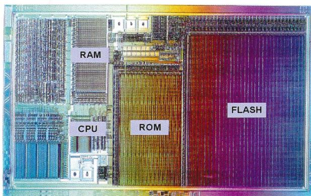
Bild 1. Fotografie eines Smart-Card-Mikroprozessors (Gemplus).
