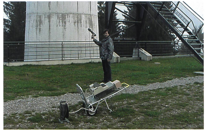
Bild 5. Spektrumanalysator zusammen mit tragbarer, handlicher Richtantenne.
