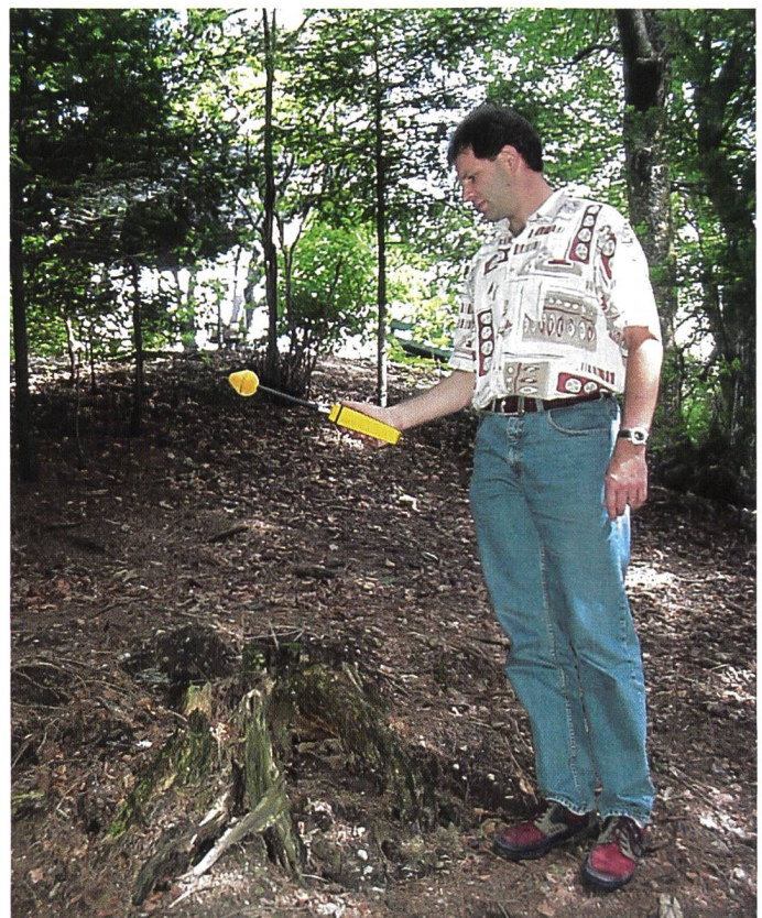
Bild 4. Tragbares Messgerät mit isotrop wirkender Antenne.
