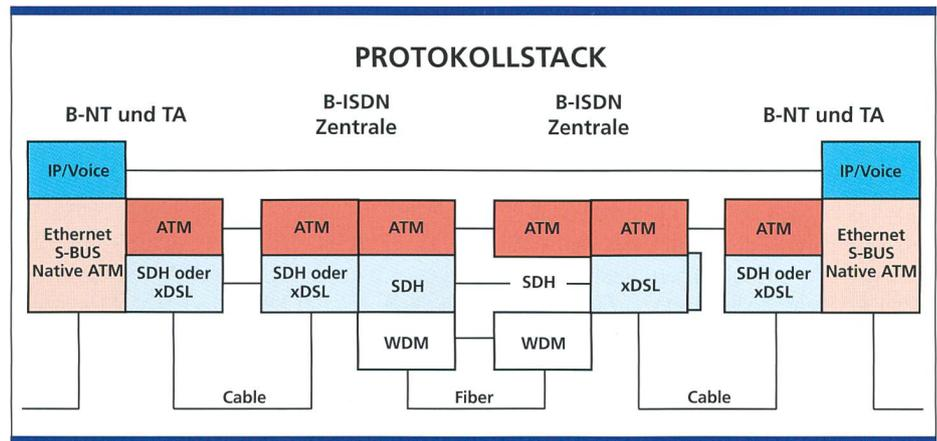
Bild 3. Protokollstack für das Breitband-ISDN.
