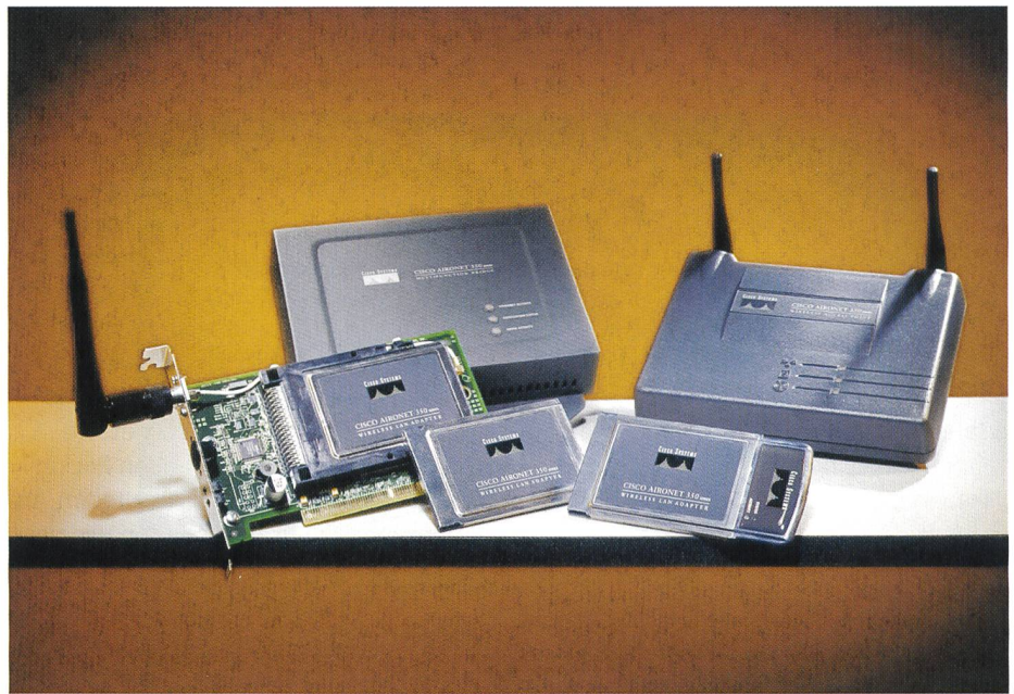
Bild 7. Gerätefamilie Cisco Aeronet 350 zur Realisierung von WLANs. Hinten im Metallgehäuse: Wireless Bridge 352 für Site-to-Site-Verbindungen (AIR-BR350-E-K9). Hinten mit zwei Antennen: Wireless Access Point 352 (AIR-AP352E2C). Vorne links: PCI-Karte für Desktop-PC (AIR-PCI352). Vorne Mitte: LMC-Karte für Geräte mit PCMCIA-Slot, jedoch externer Antenne (AIR-LMC352). Vorne rechts: PCMC-Karte für Laptops (AIR-PCM352). Anmerkung von Cisco: Alle Geräte verwenden einen Schlüssel mit 128 Bit.
