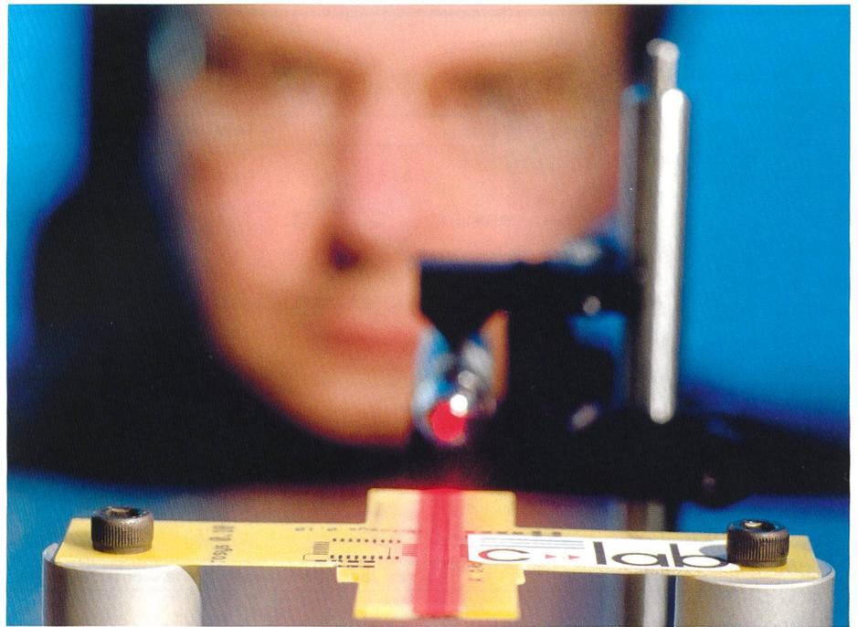
*Bild 3. Forscher am C-Lab, einer Kooperation zwischen der Universität Paderborn und Siemens, haben eine Leiterplatte (Bild unten, im Querschnitt) entwickelt, die Daten über optische Verbindungen übermittelt. Das ist ein wichtiger Schritt zu einer rein optischen Datenkommunikation.*
