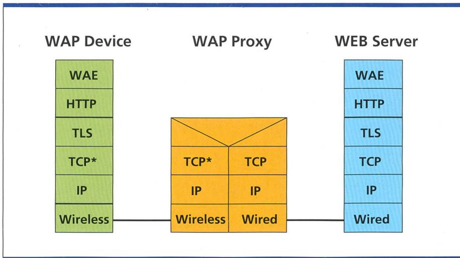
Bild 5. Beispiel eines WAP-Proxys mit TLS-Tunnelung (WAP: Wireless Application Protocol, WAE: Wireless Application Environment, HTTP: Hyper Text Markup Language, TLS: Transport Layer Security, TCP: Transmission Control Protocol, TCP\*: Profilled Transmission Control Protocol, IP: Internet Protocol).
