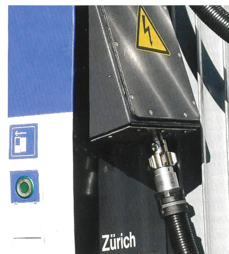
Bild 9. Verbinder zwischen zwei ICC-Wagen (ein Repeater versorgt die Antennen in mehreren ICN-Wagen).
