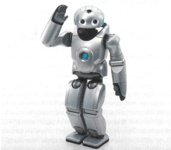
Bild 4. Zu den ersten für den Endverbraucher bestimmten Robotern gehörten der Aibo-Hund und der Qurio-Roboter von Sony. Beide stellen einige Anforderungen an die Rechenleistung des Roboter-Prozessors. Sony
