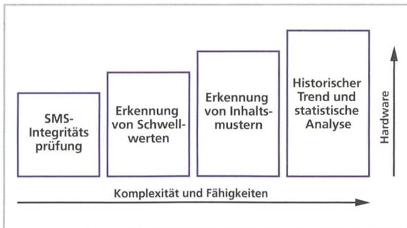
Bild 1. Vier Sicherheitsstufen zur Viren- und Spam-SMS-Erkennung.
