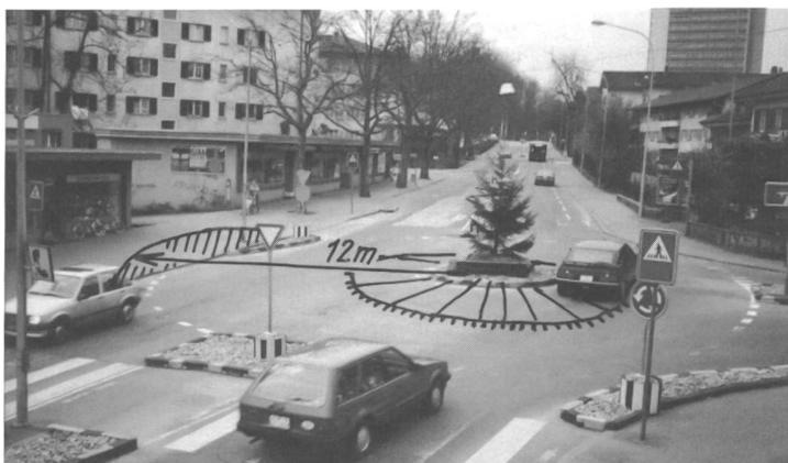
**Weil zu schnell gefahren wird, soll der Durchmesser des Kreisels von 17 m auf 24 m (normgerecht) vergrössert werden. Benötigt werden für Fussgänger reservierte Flächen. Um tiefere Geschwindigkeiten zu erreichen, wäre es besser, den Durchmesser auf 20 m zu erhöhen und eine Kreisfläche von 10 m Aussenmass um das Zentrum als Schwelle auszubilden**
