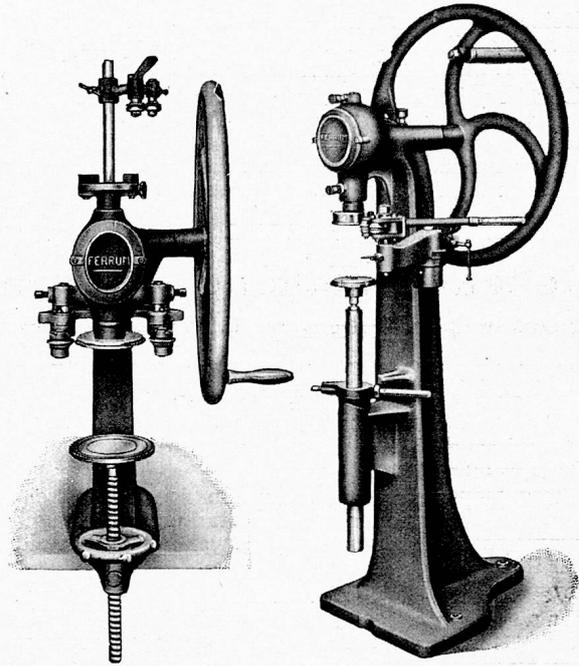
arbeitenden Dosenverschleißmaschine, wie solche obenstehend abgebildet sind. Die Maschinen werden hergestellt von der Ferrum A.-G. in Ruppertswil bei Aarau. Vorsicht ist geboten bei Verwendung von verschiedenen „Patent-Dosen“, die ohne Maschine verschlossen werden können. In vielen Fällen vermögen diese Dosen nicht zu genügen. Es darf darauf hingewiesen werden, daß nur ein Verschluß der Dosen, wie solcher auch in den Konservenfabriken bewerkstelligt wird, voll genügen kann.
