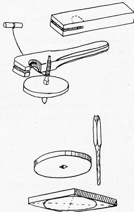
die runde Scheibe wird ein Brettchen von 1 cm Dicke verwendet. Genau in seiner Mitte wird ein quadra-
