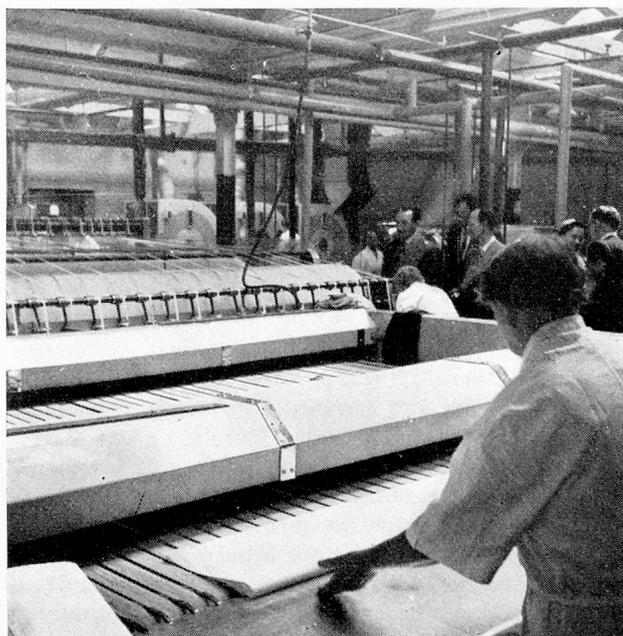
Die Leintücher kommen aus der Menge in den Faltapparat und verlassen die Maschinen zweimal längsgefaltet.
