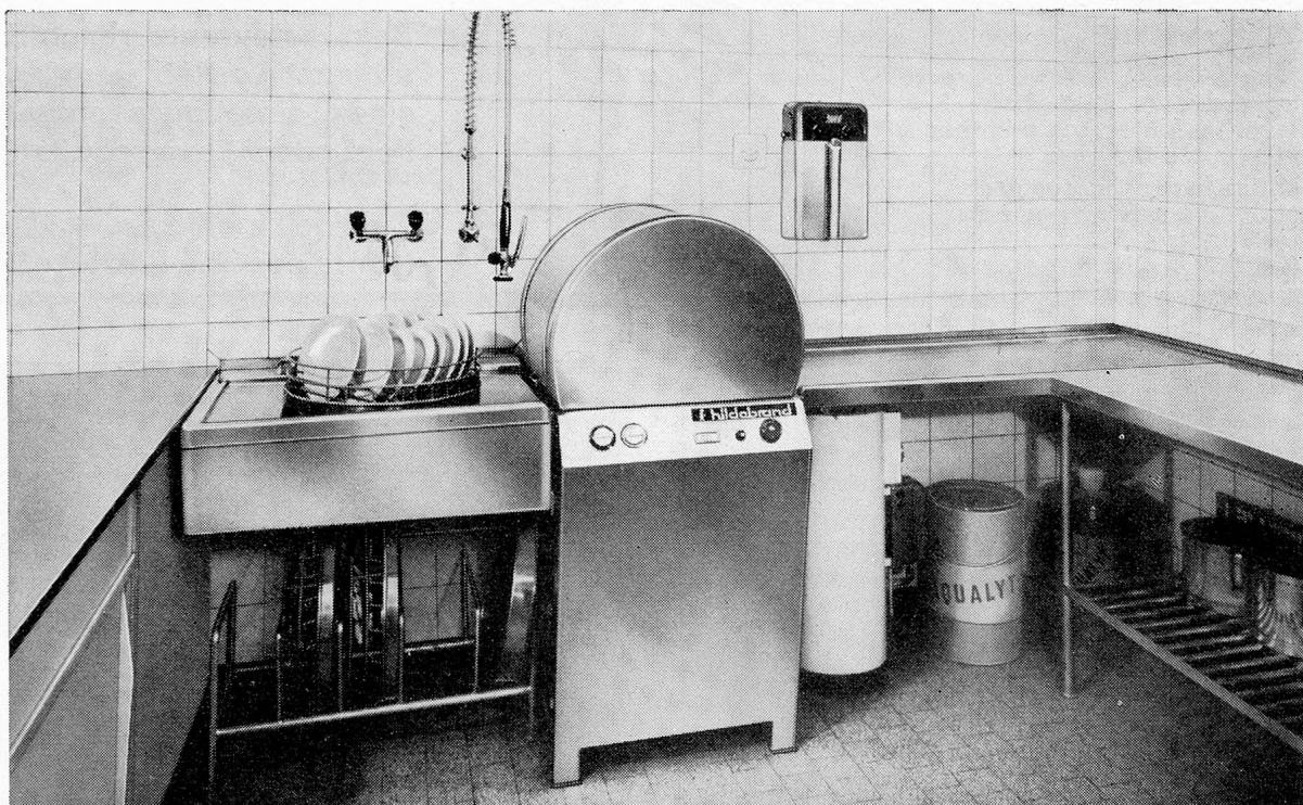
Modell H-60. Durchschiebemaschine mit vollautomatischer Programmsteuerung. Drehender Geschirrkorb mit doppeltem Wasch- und Spülsystem. Glanztrocknung mit Mikrodosierapparat HILDEBRAND H-59.
