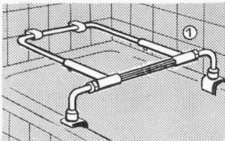
① **Bade-Helfer**, wird am Wannenrand oder an der Wand montiert. Sichere Stütze beim Einsteigen oder Verlassen der Badewanne aus eigener Kraft.
