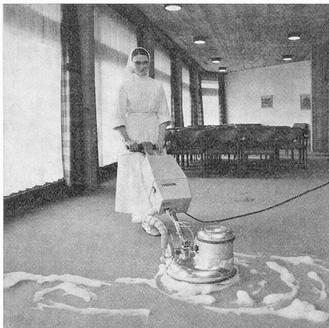
Beim Shampooieren in einem Alters- und Pflegeheim. Mit einer Einbürsten-Bodenreinigungsmaschine, ausgerüstet mit Shampooierbürste und dem Shampoo — einem Schaumaggregat mit elektronisch gesteuerter Shampoofeuchtigkeit zwecks Anpassung an Verschmutzung und Teppich. Bei Verwendung des Wetrok-Shampoo Opital wird so in einem Arbeitsgang gereinigt und gleichzeitig desinfiziert.
