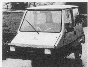
KABINENROLLER, 2-Takt-Motor 50 ccm, 1 Platz, 25 km/h
