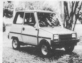
Mini-Auto mit Dieselmotor 325 ccm, 2 Plätze, 40 km/h
