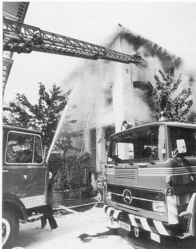
Autodrehleitern der Feuerwehr sind eine Notmassnahme bei einer Evakuation.
