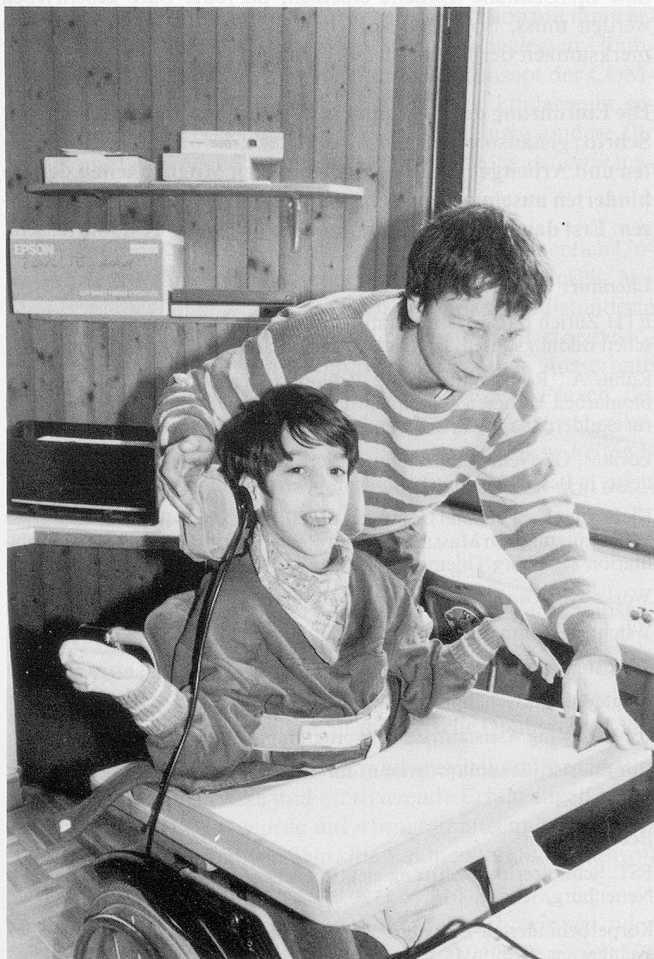
Die pneumatische Dose: Michael bedient seinen Sprechcomputer per Knopfdruck über eine einfache Gummidose.
