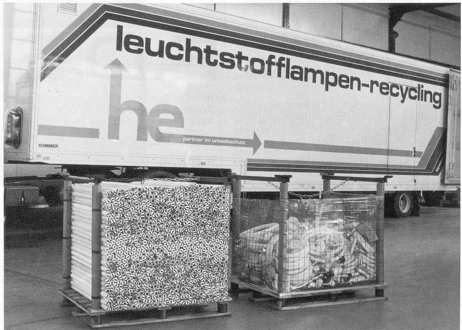
Die Entsorgungsanlage ist in einem Spezialcamion untergebracht und steht in einer Werkhalle der SBB in Dulliken SO. Die drei Millionen Franken teure Anlage hat ein Leergewicht von 25 Tonnen.
