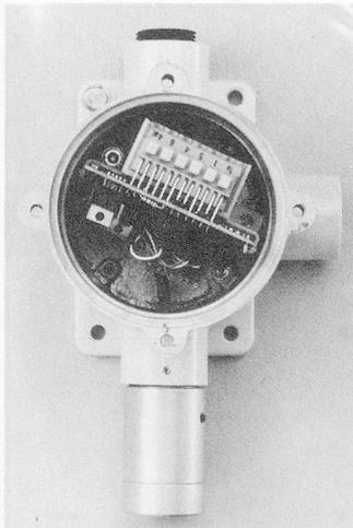
CerGas, das neue Cerberus Gasmeldesystem von Cerberus. Die Aufnahme zeigt einen geöffneten Gasmelder. Gut sichtbar sind die steckbare (und damit spielend auswechselbar) Elektronik, die eine genaue Anpassung an die örtlichen Verhältnisse erleichtert, sowie das robuste Gehäuse. Die Gasmelder verfügen über drei
