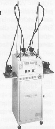
Mit eingebautem Dampferzeuger aus rostfreiem Stahl (5 l), elektronische Niveauekontrolle, Speisewasserpumpe, Dampfdruckregler, Überdrucksicherheitsventil, Abschleimhähnen, 2 Dampf bügeleisen Swiss-Matic Typ B oder BMS, Speisewassergefäss aus rostfreiem Stahl (10 l), Gerät auf Untersatz mit vier Lenkrollen
