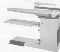
Tischblatthöhe verstellbar von 80–95 cm, rostfreies Tischblatt (XL 125 x 50 x 23 cm), thermostatgeregelte Tischblatt-Temperatur, Dampfabsaug-Ventilator auf breiter Fussleiste steuerbar, Absaugperre des Tischblattes beim Arbeiten mit dem Ärmelbügler, Abstellfläche für Dampfbügeleisen, Auffangtuch für Bügelgut
