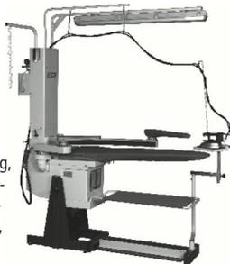
Die mit einer Gasfeder unterstützte Höhenverstellung macht das Einstellen der ergonomisch richtigen Tischblatthöhe sehr einfach.
