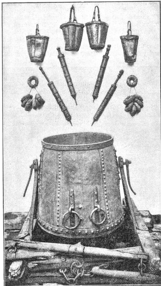
**Nürnberg'sche Löschgeräte.** Kupferne Wasserkufe, 300 Liter fassend, befestigt auf einer Schiefe für Bespannung mit zwei Pferden; messingene Handfeuerlöschspritzen von 1499 und 1544; Ledereimer; Darzlinge zur Beleuchtung des Brandplatzes. — Aus Branddirektor Wolfersmann's Denkschrift.
