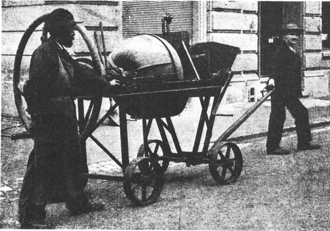
Fig. 24. — Lausanne, 1908. Machine à mélanger le sable, le gravier et le ciment, dite bétonnière. Brevet Von Roll.
