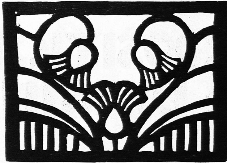
Fig. 6. Le travail au vaporisateur. Les surfaces blanches sont ajourées tandis que les noires formant chablon retiennent la couleur vaporisée.
