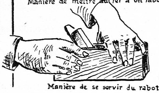
Manière de mettre du fer à un rabot.
