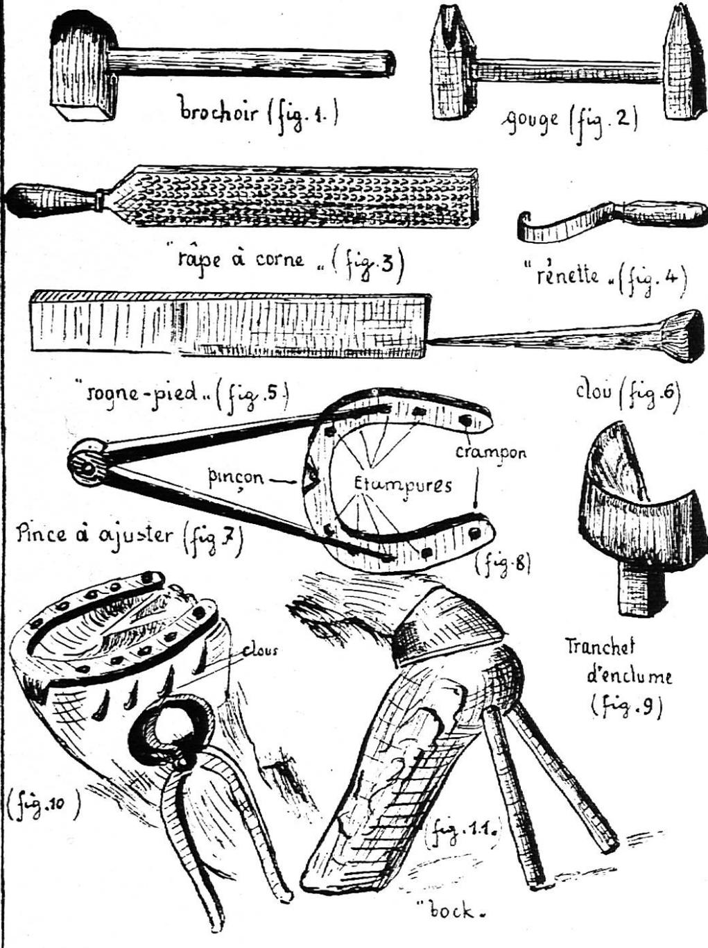
mence l'opération plusieurs fois s'il le faut, enlève encore un peu de corne, entaille le devant du sabot où s'incrusterà le *pinçon*, donne au fer réchauffé sa forme définitive, le coupe à l'aide du tranchet d'enclume, arrondit ses extrémités, corrige l'inclinaison du *pinçon* (fig. 8 et 9).
