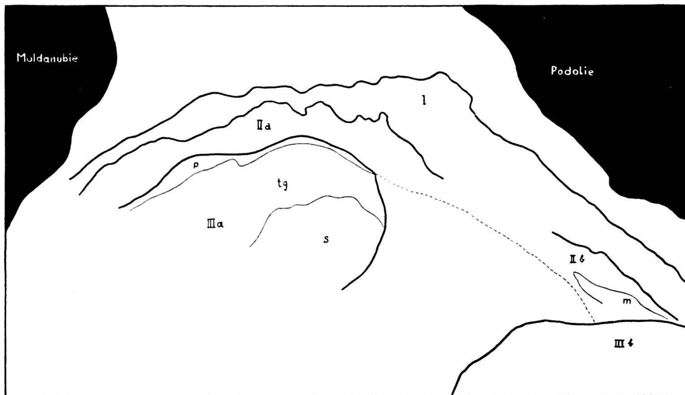
Fig. 1. Esquisse tectonique des Karpathes. I = Ceinture externe des nappes du flysch. IIa = Petit arc des nappes de Magura. IIb = Petit arc de la zone interne du flysch des Karpathes orientales. IIIa = Bloc des Karpathes centrales de la Slovaquie. IIIb = Bloc des Karpathes centrales de la Roumanie. p. = zone des Piénides. tg = zone des Tatrides et des Granides. s = unité du Spiš (Gémérides). m = noyau cristallin de la zone IIb.
