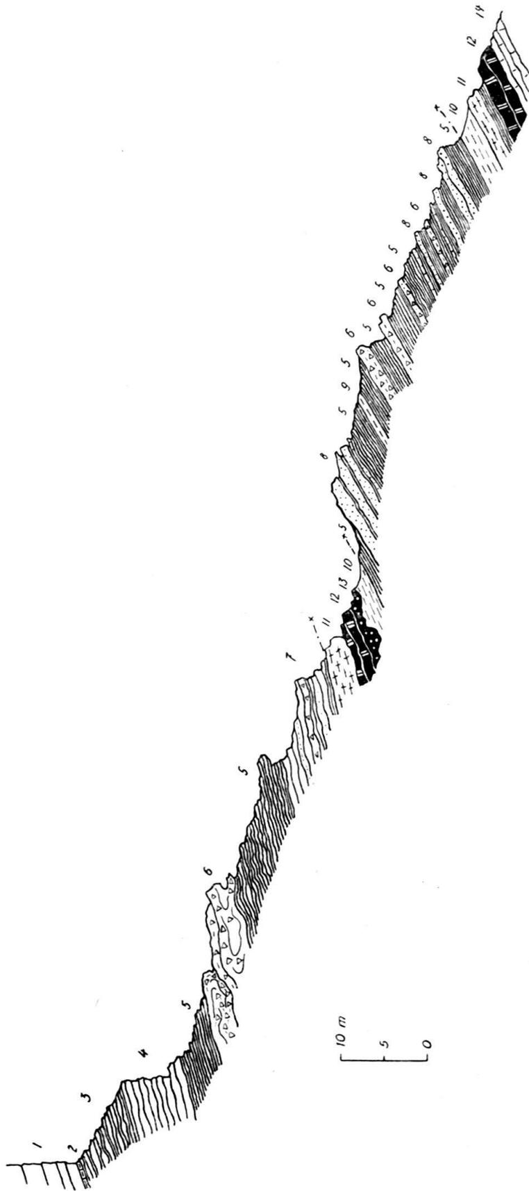
Fig. 18. Profil durch die Dogger-Zone der Gelbhorn-Decke, mit Verschüppungen der Bruschgorn-Schuppe. Gelbhorn-Nordgrat.
