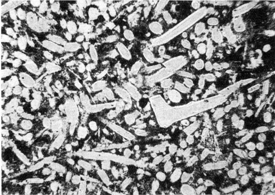
Fig. 4. Galet L 10, station de Baumaroche II. Spongolithe ; spicules calcédonieux dans une gangue calcaréo-cherteuse. 36:1, lumière naturelle.
