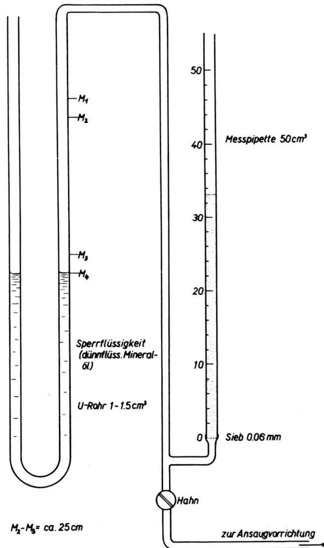
Fig. 1. Schematische Darstellung der Apparatur zur Bestimmung der wirklichen spezifischen Oberfläche von Sanden.
