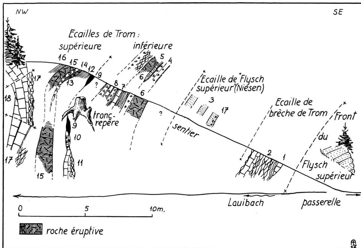
Figure 1. Coupe schématique des affleurements de roche éruptive associée à la Brèche de Trom. Sentier de Trom; rive droite du Lauibach.
