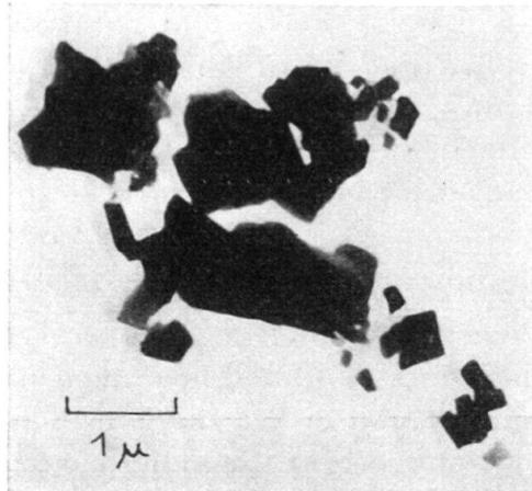
Fig. 1. Elektronenmikroskop-Aufnahme der in Essigsäure unlöslichen, feinsten Schlämffraktion eines roten Mergels der Bunten Scaglia (Breggia-Schlucht, Süd-Tessin). Die Natur der winklig umgrenzten Partikel kann nicht erkannt werden. Vergrösserung 10000  $\times$ .
