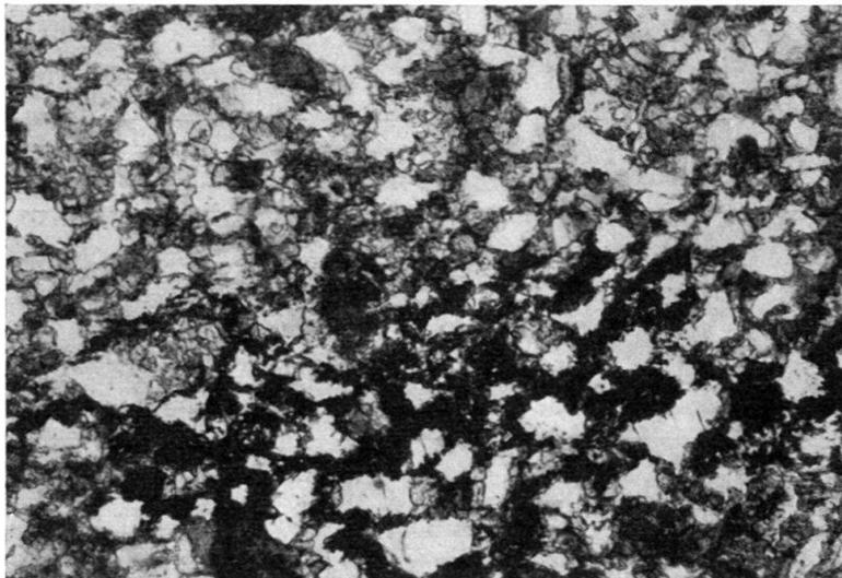
Fig. 8. Eisensandstein des Aalénien. Hell = Quarz und Kalzit. Dunkel = rostiges Pigment. Ils Aults Westseite (27 ×).
