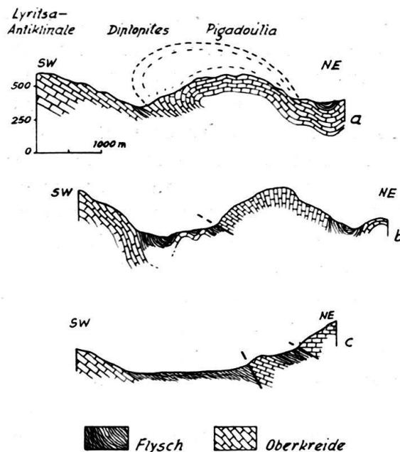
Fig. 8. Die schiefe Falte Pigadoulia. a) bei Diplopites, b) etwas südlicher mit 2 kleinen sekundären Aufwölbungen, c) noch weiter nach S, wo die Falte abgebrochen und schuppenweise vorgeschoben ist (Profiltr. s. Fig. 5).
