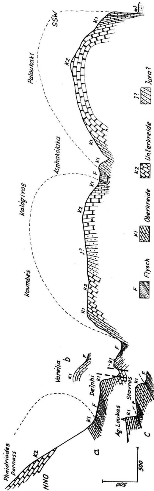
Fig. 2. Schematisiertes Profil durch die Synklinale von Delphi und die Koumbes- und Paloukiantiklinalen. In Perspektive die Vareiaaufwölbung und die Stavrosschuppe (Profilr. s. Fig. 1)
