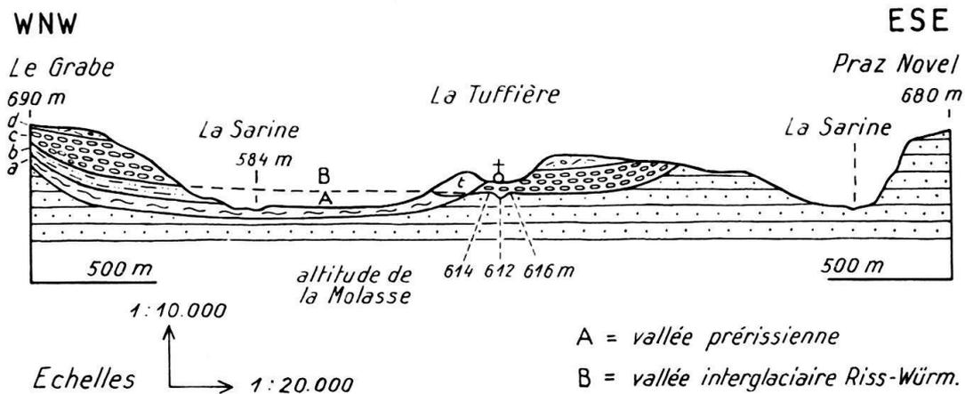
Fig. 28. Profil schématique dans les cours anciens et épigénique de la Sarine à la Tuffière
