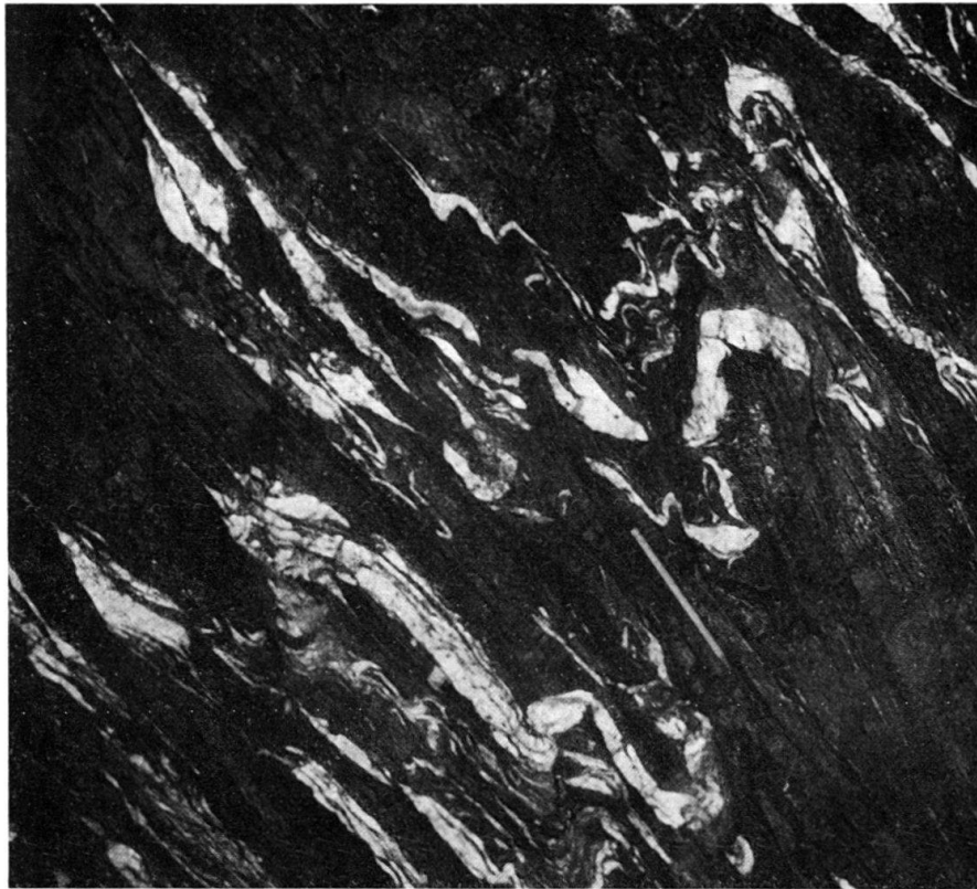
Fig. 7. Im Malmkalk des Pfaffenkopfkeils wird eine erste Schieferung (mit parallelen Calcitlagen) durch eine zweite, steilere gefaltet. Druckstollen Trift-Speicherberg, m 2720 ab Trift.
