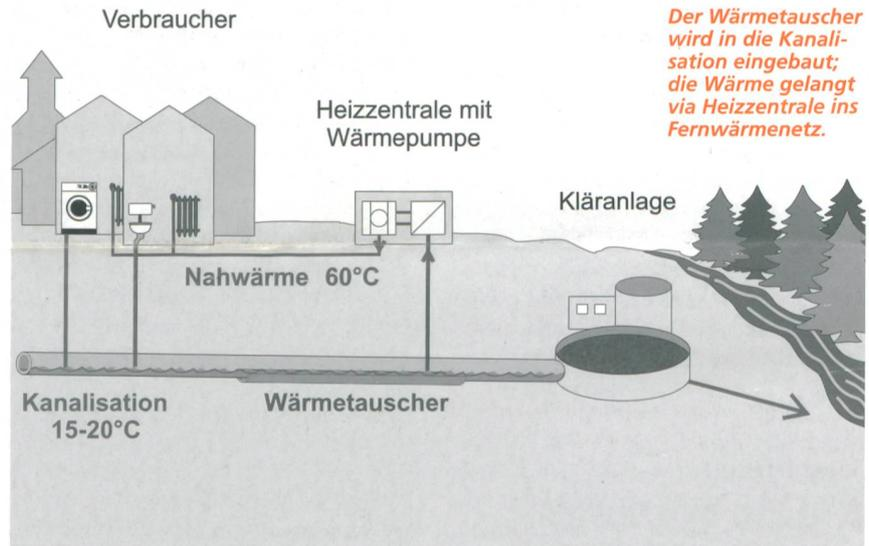
**So funktioniert:** Ein Wärmetauscher wird in einen Abwasserkanal installiert. Dieser entzieht dem Abwasser Energie, die mit einer Wärmepumpe für Wassererwärmung und Raumheizung nutzbar gemacht wird. Bei sehr kalten Aussentemperaturen wird die Wärmepumpe durch eine konventionelle Heizung unterstützt. In realisierten Projekten deckt die Abwasserwärme 50 bis 80 Prozent des Energieverbrauchs.
