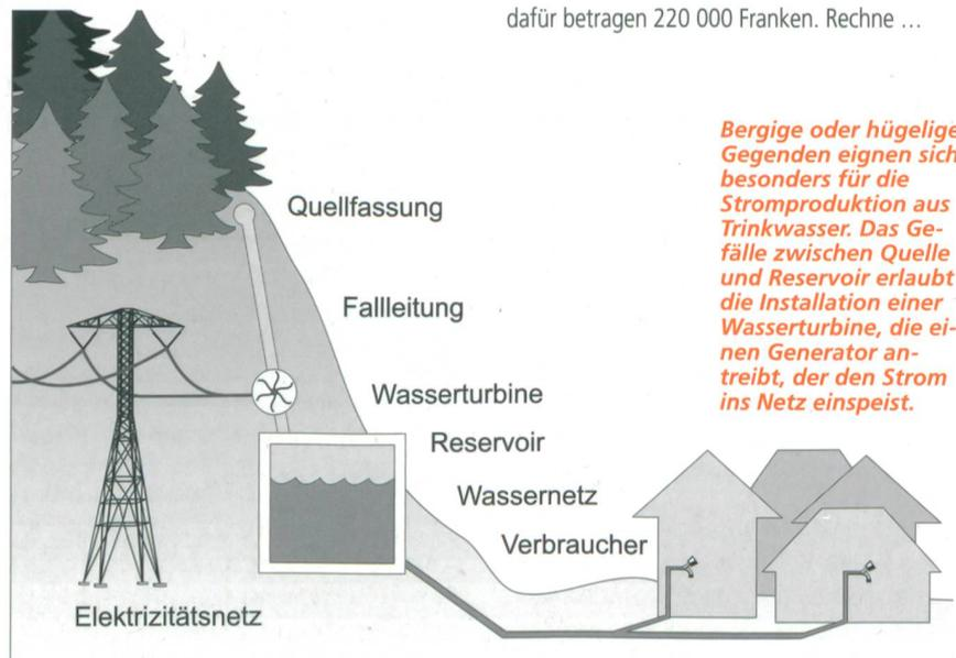
Bergige oder hügelige Gegenden eignen sich besonders für die Stromproduktion aus Trinkwasser. Das Gefälle zwischen Quelle und Reservoir erlaubt die Installation einer Wasserturbine, die einen Generator antreibt, der den Strom ins Netz einspeist.
