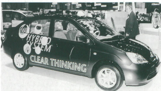
Der Toyota Prius ist das erste serienmässige Hybrid-Auto. Mit einem kombinierten Benzin-Elektroantrieb schluckt es im Schnitt um die 5 l/100 km.
