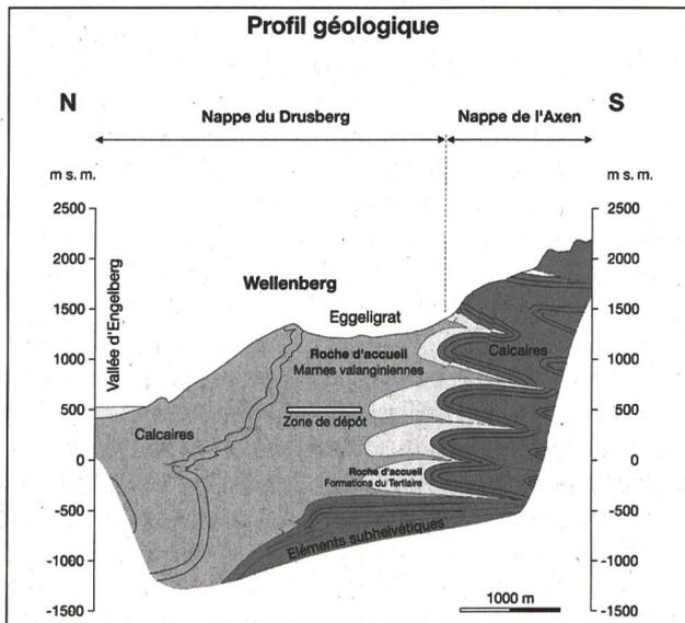
Profil du Wellenberg, perpendiculaire aux grandes structures géologiques. La roche dans laquelle le dépôt serait creusé au niveau de la vallée est formée de marnes valanginiennes et tertiaires. Les investigations menées ont montré la réelle étanchéité de cette roche argileuse. Quant aux traces de nappe phréatique trouvées dans la région potentielle du dépôt, elles sont enfouies dans la montagne depuis plus de 10 000 ans et sans aucun contact avec la surface.
