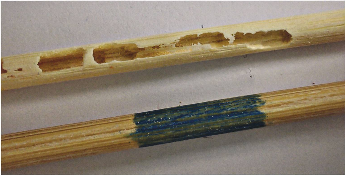
Abb. 2. Mikado-Stäbchen aus Bambus mit Frassspuren von Dinoderus minutus . (Foto C. Germann)
