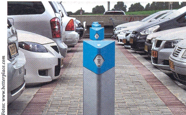
Parkieren, auftanken – so einfach ist das System von «better place». Und wenn die Zeit drängt, so wird dem Elektrowagen innert 5 Minuten ein neuer Akku eingesetzt.
