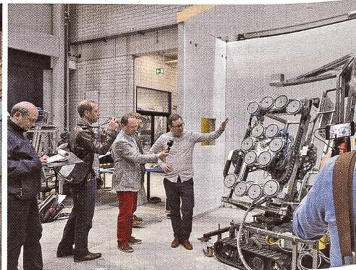
Karlsruher Technisches Institut: Wird ein AKW stillgelegt, muss grossflächig dekontaminiert werden, was bisher unter grossem Risiko von Menschenhand erfolgte. Das Institut entwickelt Roboter, welche diese Arbeiten den Menschen abnehmen können. Die Prototypen funktionieren. Es braucht aber Geld und Investoren.
