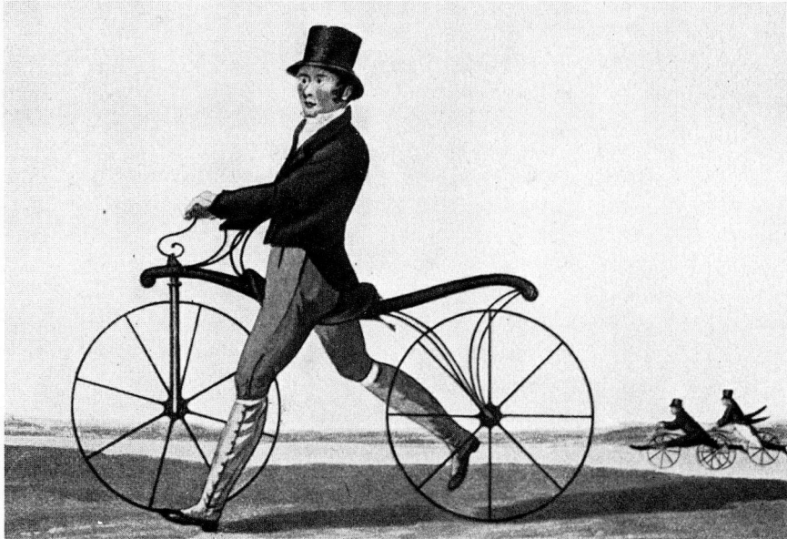
Nach dem Erfinder Drais wurde das erste Fahrrad Draisine genannt. Es war eine sog. Laufmaschine und kam 1817 auf die Strasse. Anfänglich vollständig aus Holz gebaut, wurde es aber bald (England) mit Rädern und Gabeln aus Eisen versehen.
