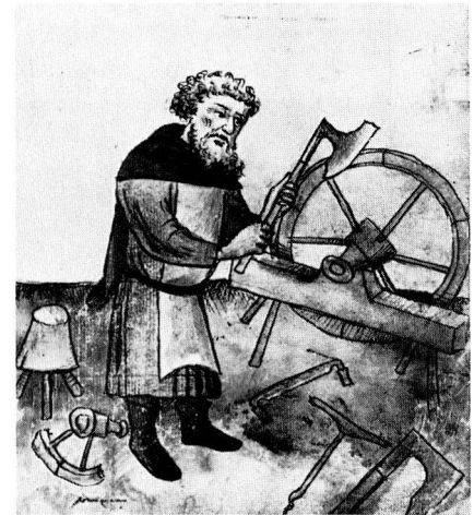
Wagnermeister aus dem späten Mittelalter (Nürnberg): Er arbeitet bereits an einem Speichenrad.
