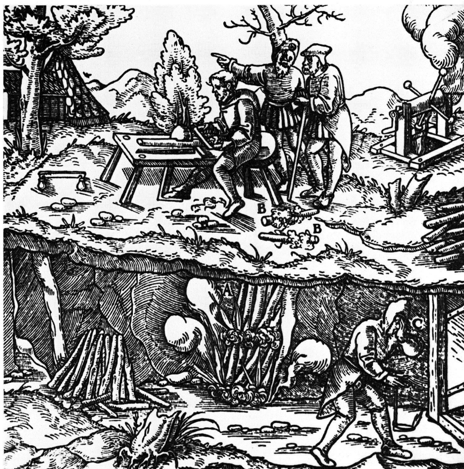
Bild 3: Technik des Feuersetzens im 16. Jahrhundert (nach Georg Agricola) 2 .
