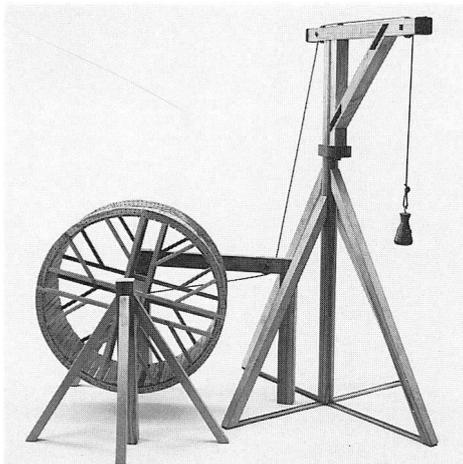
Modell eines Baukranes für den Augsburger Rathausbau.<sup>5</sup>
